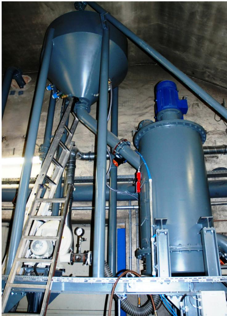
Abb. 4 Pufferbehälter und Reibregenerator
