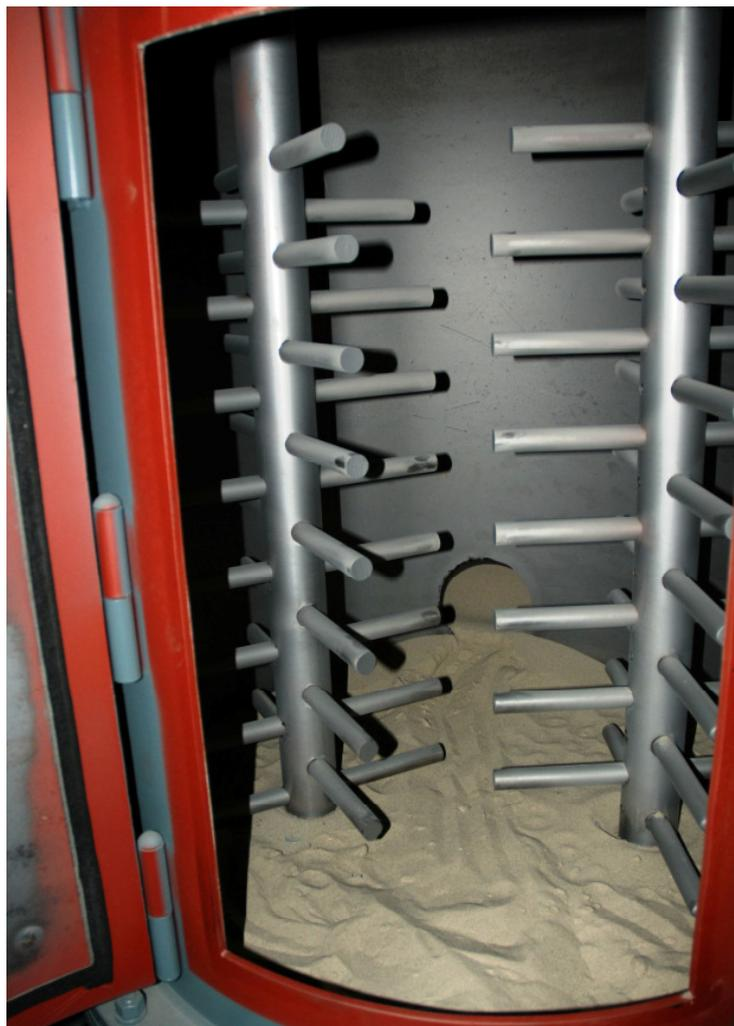
Abb. 6 Reibregenerator; Innen mit neuen Rührwerkzeugen
