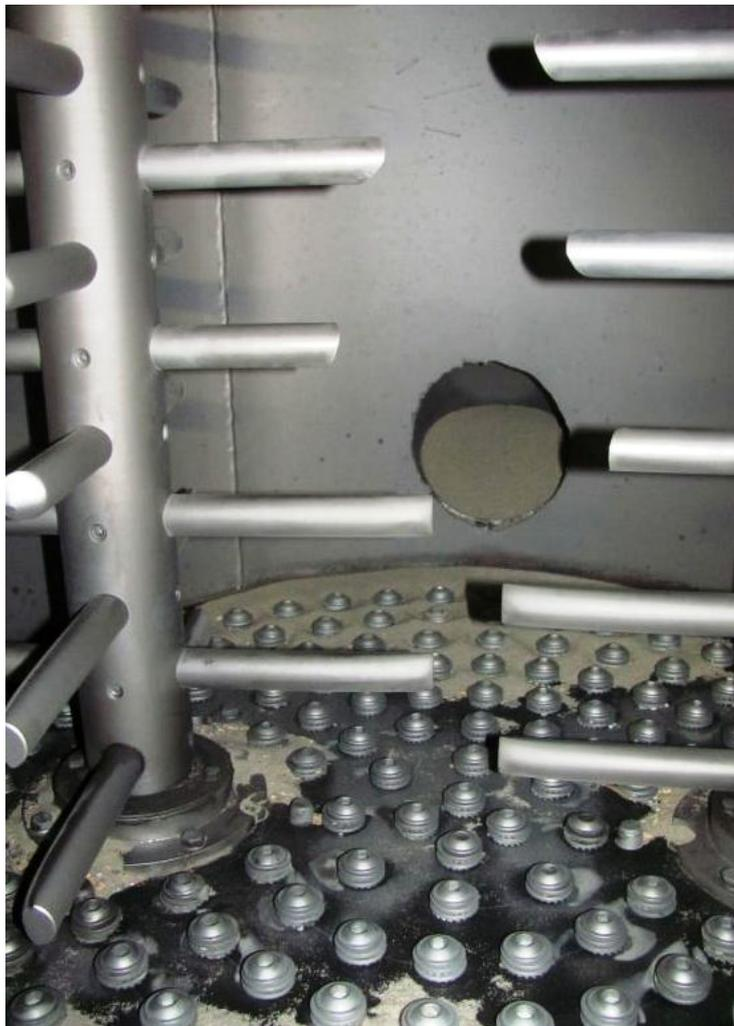
Abb. 7 Reibregenerator; Düsenboden und gebrauchte Rührwerkzeuge
