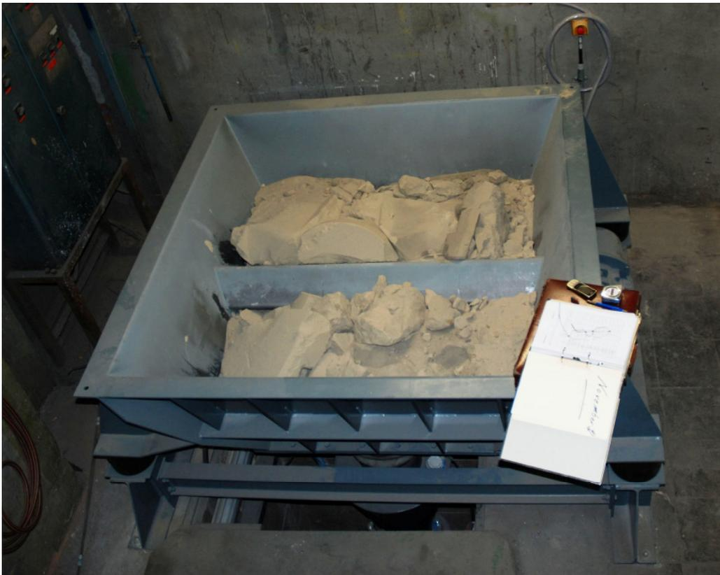
Abb. 2 Vibrations-Knollenbrecher mit Füllung
