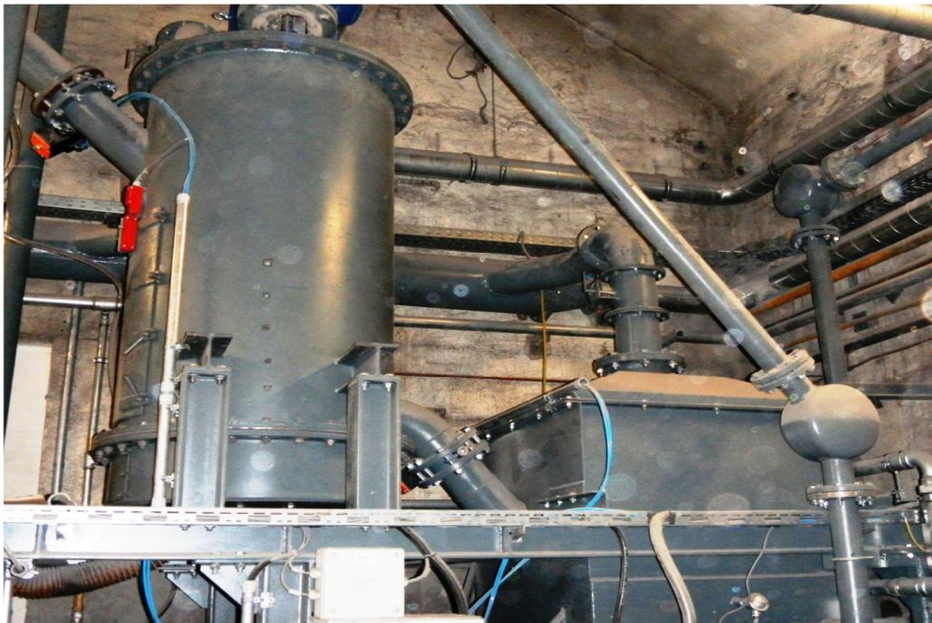
Abb. 5 Reibregenerator mit Fließbettkühlsichter
