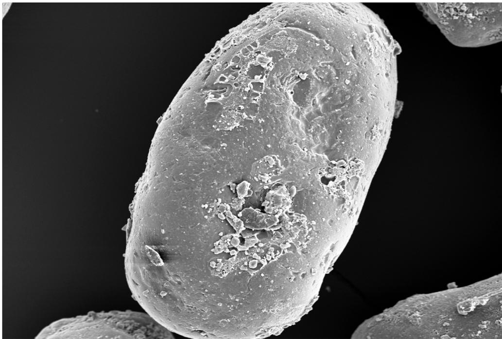
Abb. 8 Regenerat aus Pufferbehälter (5); REM-Mikroskopie; Auflösung 160:1
